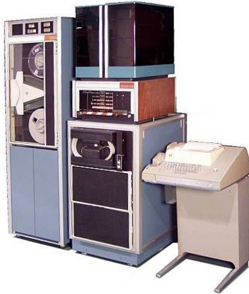
Komplett PDP 8-system med sentralenhet, tapestasjon TU 580 (fra PDP 5, 1963), hullbåndstasjon PC 01, harddisk DF 32 og teletype som printer.
